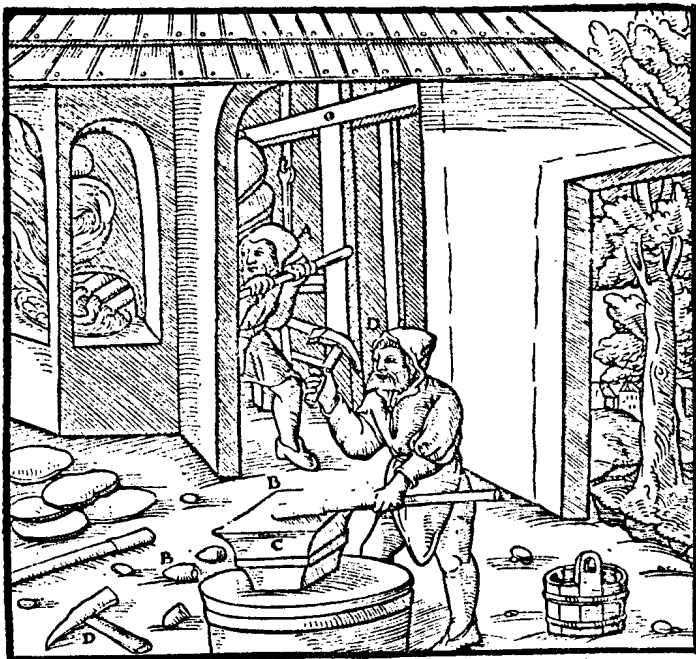
Сл. 9. (А) Шиљасти шипка за узорак (бабра); (В) узорак бабра; (С) наковањ; (D) чекић
