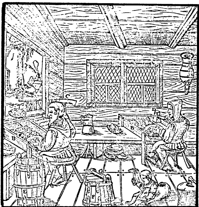
Сл. 8. (А) Сто; (В) сандуци за руду; (С) чекић; (D) четвороугаони чекић за дробљење; (Е) дубљи суд за руду; (F) плићи суд за руду; (G) гвоздена шипка
